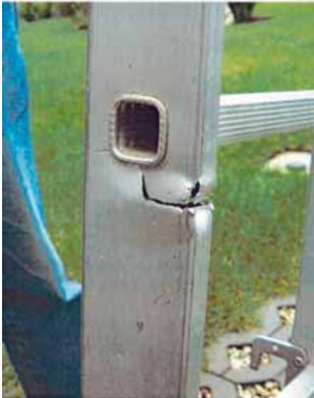
Bild 51: Stark beschädigte Leiter
