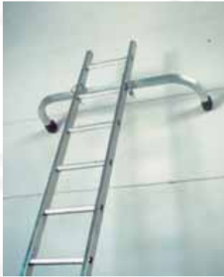
Bild 28: Wandabstützung (Verbreiterung des Leiterkopfes)
